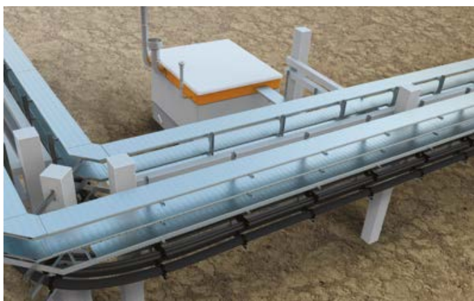
Групповая прокладка кабеля на эстакадах
